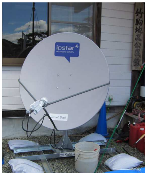
写真 5-4： 陸前高田市の避難所（竹駒コミセン）に設置された IPSTAR 社のパラボラアンテナ
